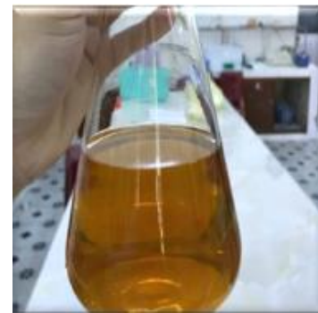
Hình 5. Dịch enzyme protease thô thu được sau quá trình nuôi cấy B. subtilis
