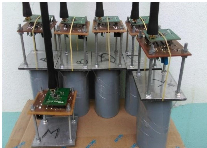
Hình 3. Module thu/phát sóng vô tuyến CC1120 – 169 MHz sử dụng trong thí nghiệm.
